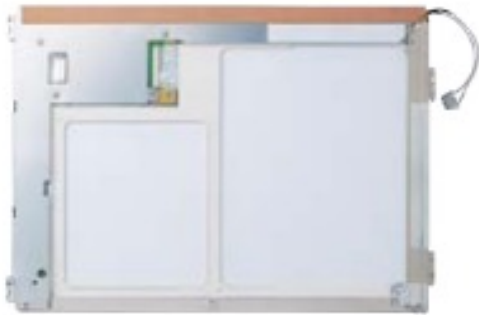
LCDユニットのシールディング (3M™ 導電性テープ)
